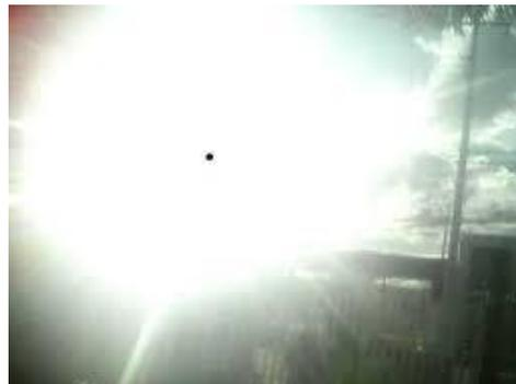
**CONCLUSIÓN:** El supuesto “objeto” es compatible con un fenómeno de sobre-exposición de los sensores tipo CMOS cuyos foto-receptores en estado de sobresaturación entregan una lectura menor de luz de la que reciben por no poder resetearse completamente en el tiempo que tiene estipulado la cámara. Este fenómeno es conocido como: “Sol negro”.
